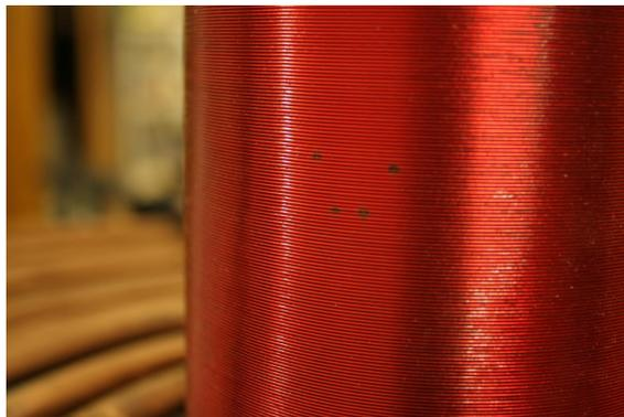
FIGURE 4.29 – Les résultats d’un surcouplage : des éclairs se sont produits entre les inductances primaire et secondaire, brûlant ce dernier en plusieurs endroits.
