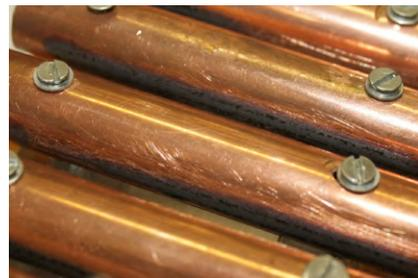
FIGURE 4.24 – Forte corrosion entre les tubes de cuivre.
