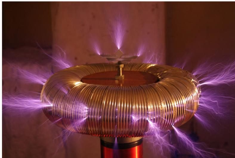
FIGURE 4.32 – Des éclairs naissant sur des aspérités de la charge terminale tout autour d'elle. Notez l'aigle de Zeus. Pose de 1 s.
