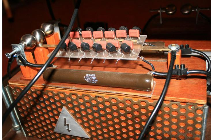
FIGURE 4.38 – Le filtre monté sur Zeus, le NST se trouve dans le boîtier sous le filtre.
