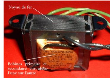
FIGURE 3.23 – Un transformateur réel. Les fils de connexion du primaire sont en noir, ceux du secondaire en vert (le fil du milieu est un connexion à la terre). [Image : Wikipedia]
