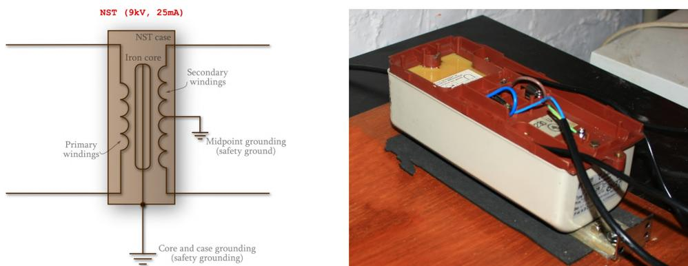
FIGURE 4.2 – Schéma et photo du transformateur type NST de Zeus (hors de son boîtier).
