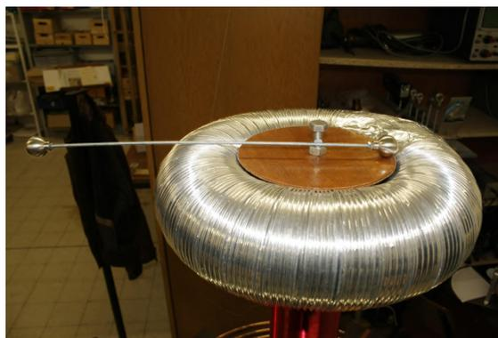
FIGURE 4.31 – Schéma et photo de la charge terminale de Zeus.
