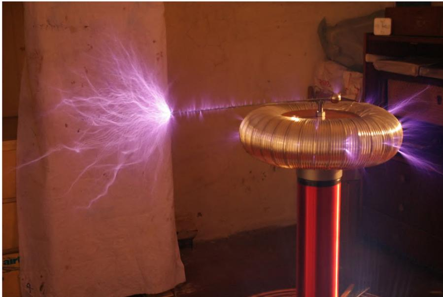
FIGURE 4.33 – Rajouter une pointe permet de forcer les éclairs à sortir à cet endroit. Leur longueur augmente par la même occasion. Pose de 3,2 s.
